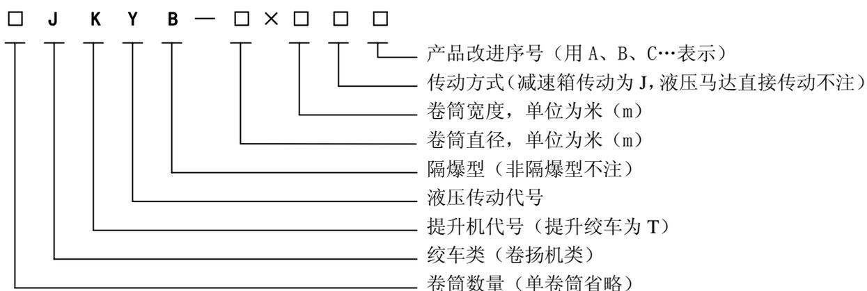
示例1：卷筒直径为 1.6m、卷筒宽度为 1.2m 液压马达直接驱动的单卷筒隔爆型液压提升绞车，型号表示为：JTYB-1.6×1.2。
