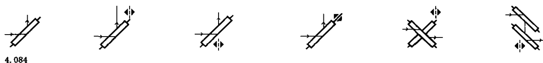
图 A.1 使用卷筒纸转向杆符号(4.084)变化的示例
